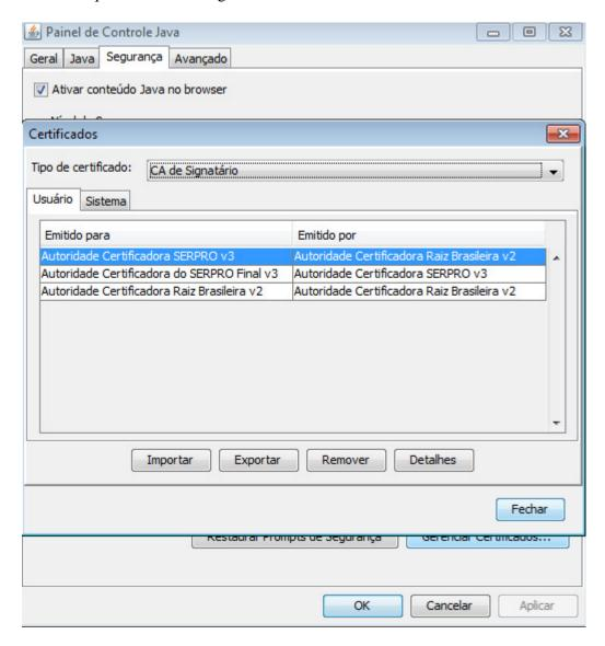
Podem existir nesse local outros certificados previamente instalados em seu computador. Mas para o funcionamento do sistema de assinatura digital os três listados na tela acima são essenciais.
